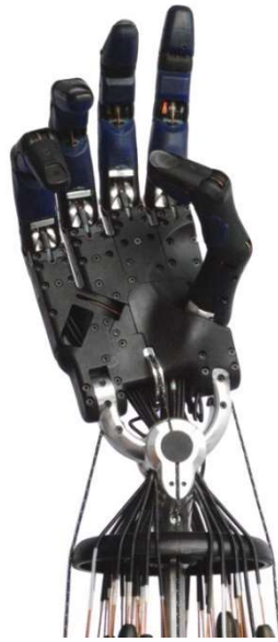
Fig.5.4 Shadow Dexterous Hand の掌 ([Shadow Robot 社 HP より])
