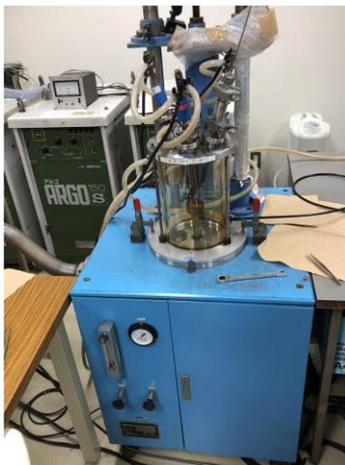
3-1図 トリアーク溶解炉
