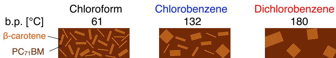
図 4.7 溶媒による活性層内分子の結晶化イメージ。
