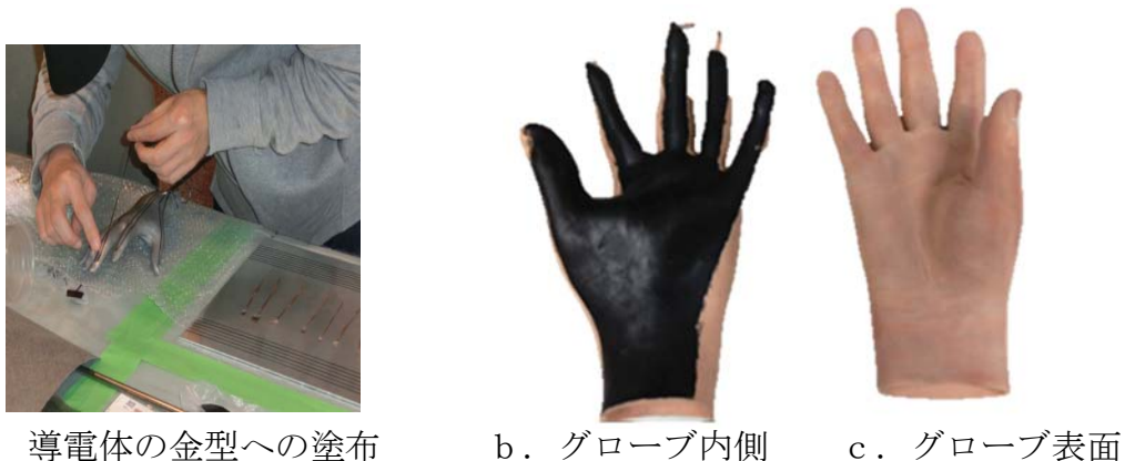
図5-7 導電性を付与した TT シリコーングローブの試作
