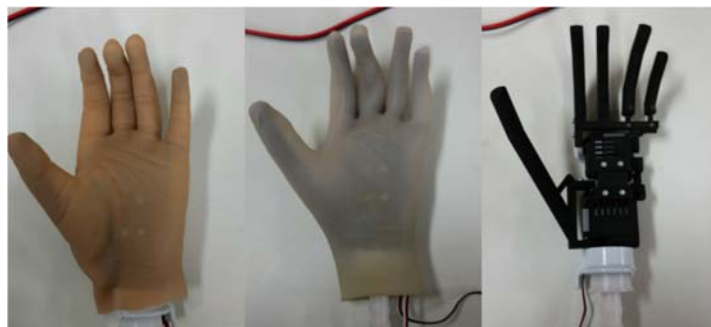
a. 塩化ビニル装着 b. エラストマー装着 c. グローブ非装着
