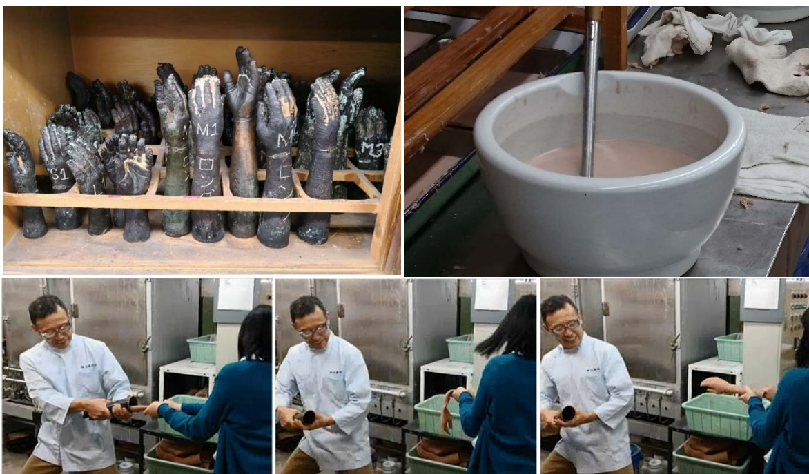
図 3-17 塩化ビニルグローブ金型（左上）と材料（右上） 製造工程（引抜き，下）
