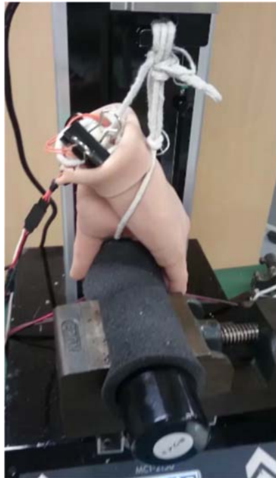
図 4-28 円柱状の物体の引抜実験
