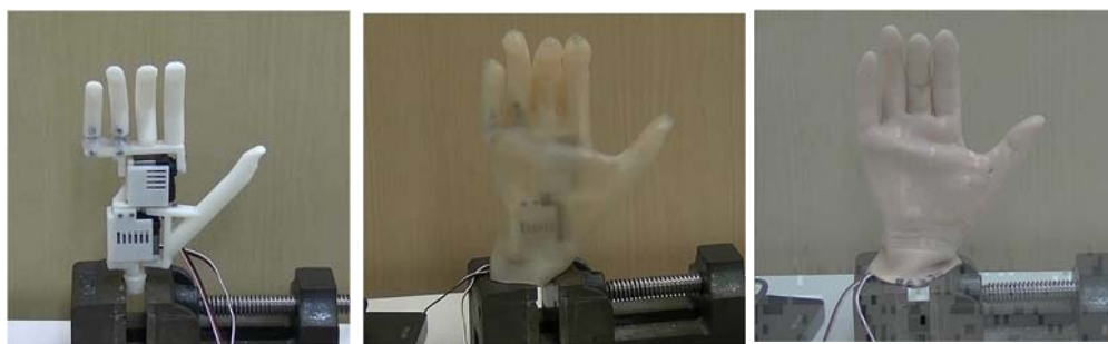
a. 手先具 b. エラストマー装着時 c. TTシリコーン装着時
