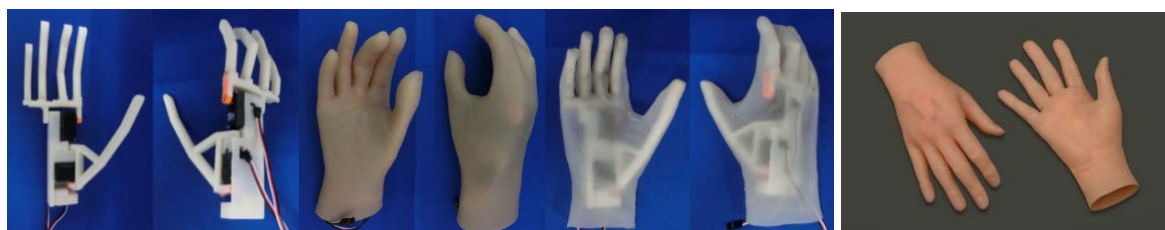
a) 手先具 b) 塩化ビニル c) エラストマー d) TT シリコーン
