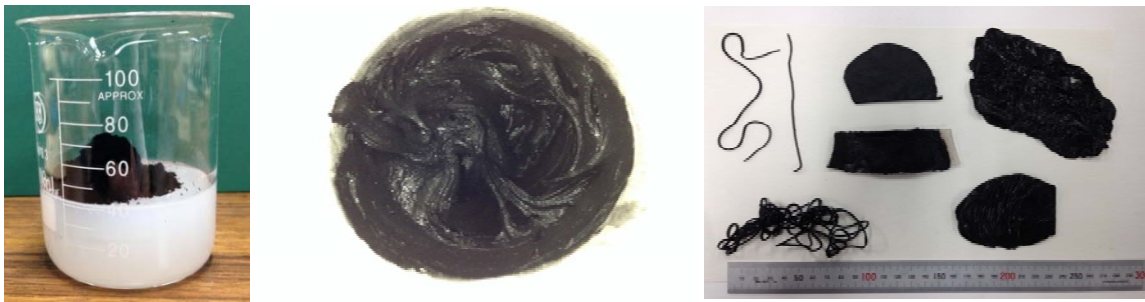
図 5-4 シリコーンゲル導電体開発実験の様子
