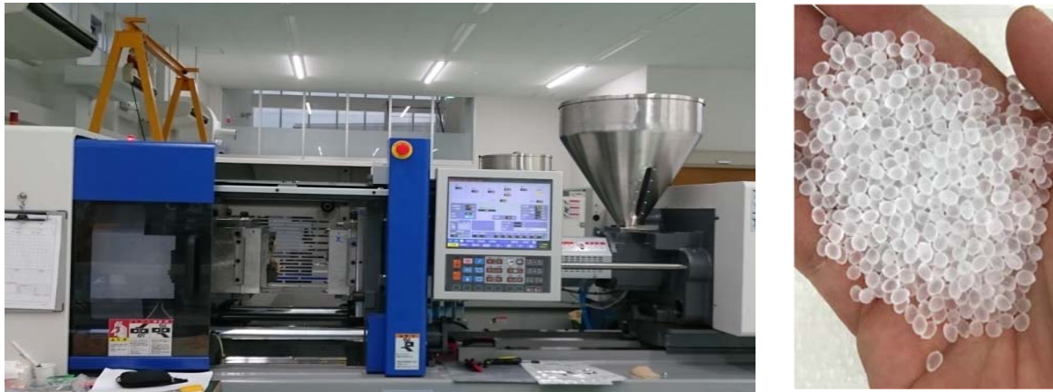
a. インジェクション成形機（撮影協力：㈱タナック） b. 樹脂材料（ペレット）
