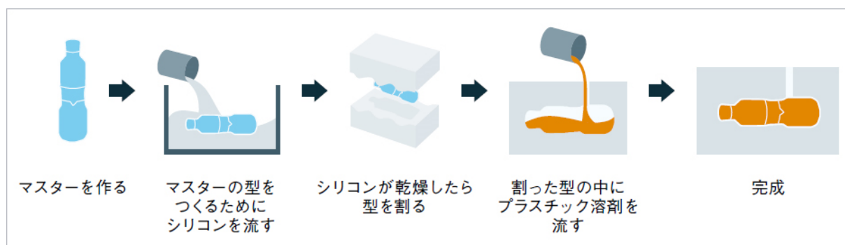
図 3-14 注型成形による TT シリコーングローブの成形方法（株）タナック提供
