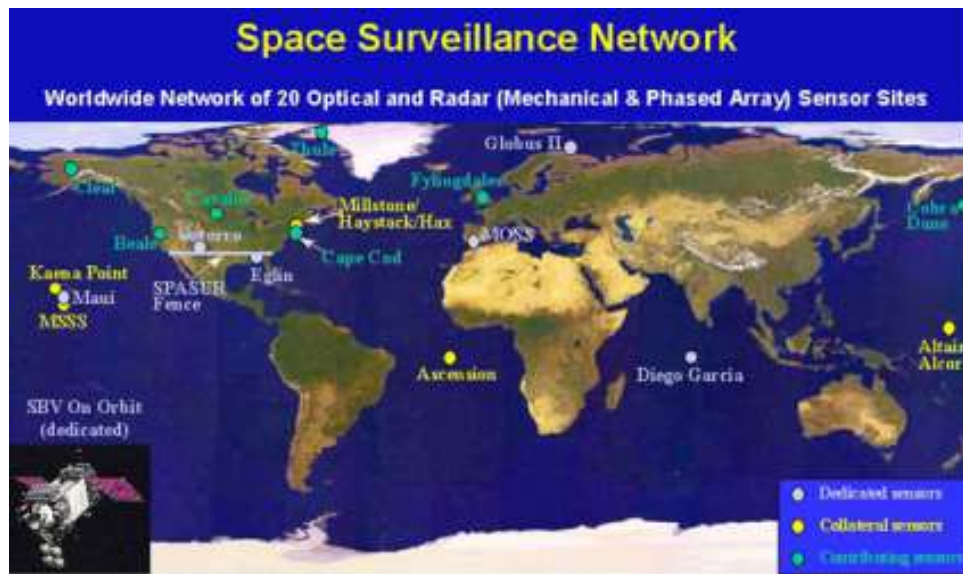
図 1.6 Space Surveillance Network で用いられている光学望遠鏡とレーダーの配置図 [1]
