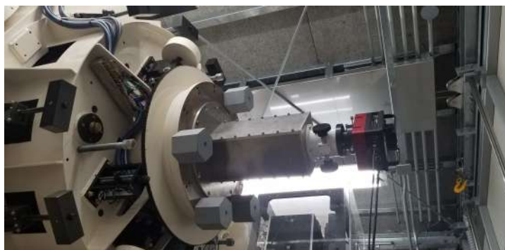
(b) 1m 望遠鏡に冷却 CCD カメラを取り付けた様子
