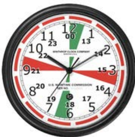
無線室の時計 (国際標準時間で赤の時間帯が電信用、緑の時間帯が電話用)
