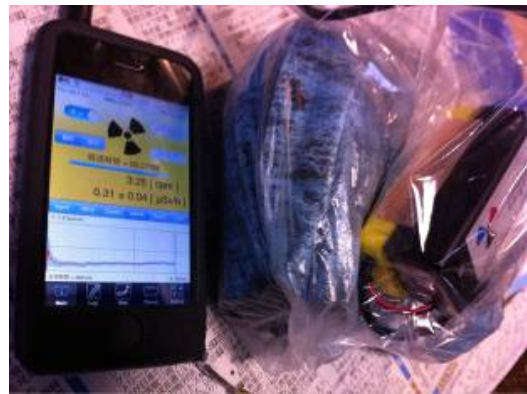
(b) 左：剪定した木の葉 (0.06uSv/h)、右：空気清浄機のフィルター (0.36uSv/h)
