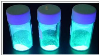
図 1.7.5  $Ba_{2(1-x)}Eu_{2x}SiS_4$  ( $x = 0.01, 0.02, 0.05$ ) の発光 (励起光: ブラックライト 365 nm).
