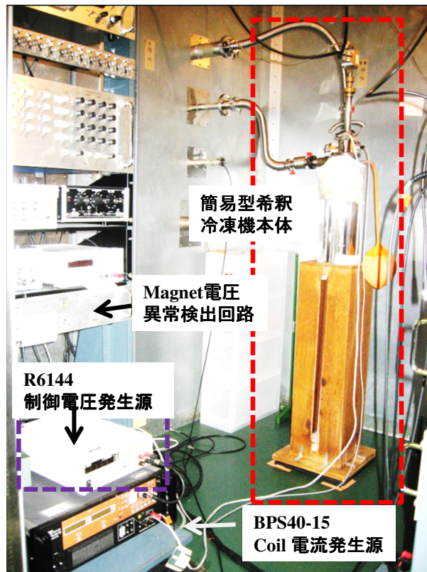
図 3.18: 超伝導マグネットの磁場発生用電流源、電流制御用電圧源、および検出回路の外観図。写真右側は簡易型希釈冷凍機。
