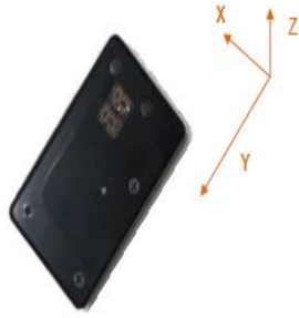
図 2 慣性センサの加速度の軸の向き
