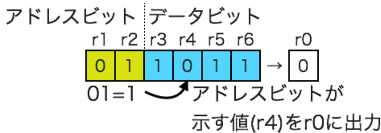
図 6.4 B3：6bit-Multiplexer の概略図
