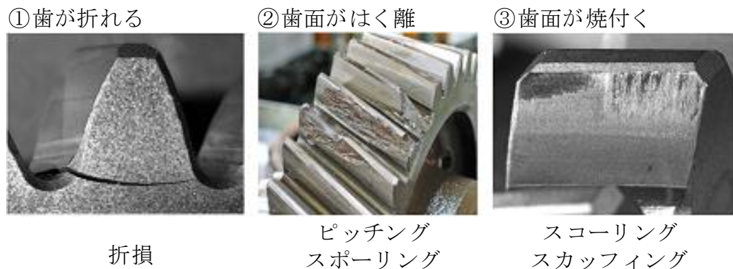
図 5.1. ギヤの主な故障モード
