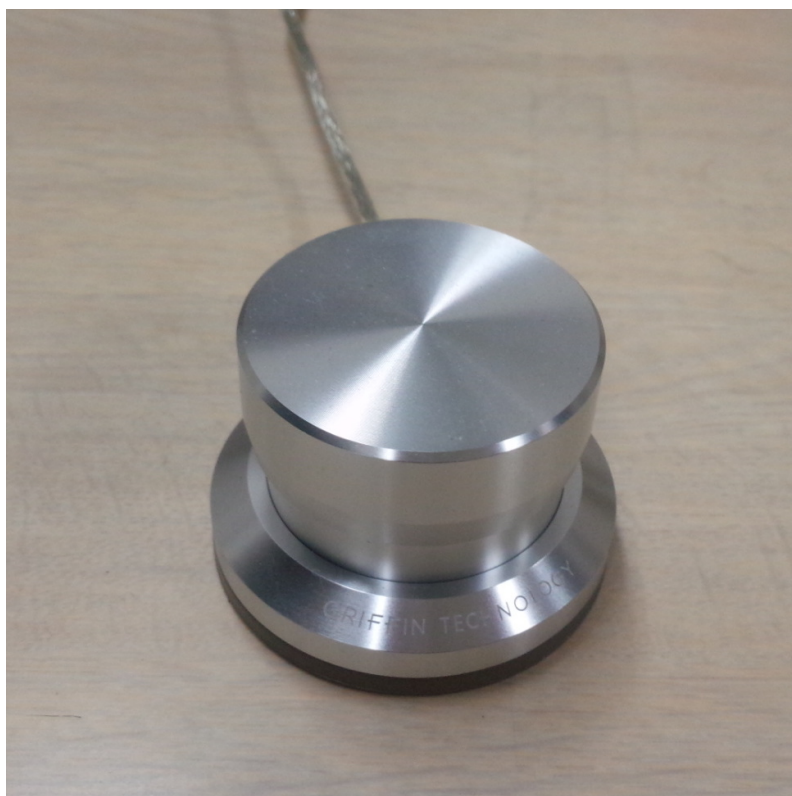
図 4.11 心理物理実験で被験者回答を得るために用いた回転デバイス（Griffin Technology 製 PowerMate NA16029）。回答が「時計回り」「反時計回り」の二択のため、回転するデバイスを用いることで被験者が直感的に扱えるよう配慮した。
