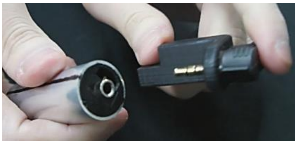
図 4-7 オーディオ端子による回転体の接続
