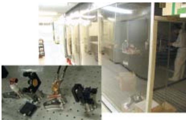
Fig.6 新しく用意されたETL専用クリーンルームとその中に設置されたチタンサファイアレーザー発振実験用光学系の一例。これらの用意、建設にもすべて学生の参加によって行われた。
