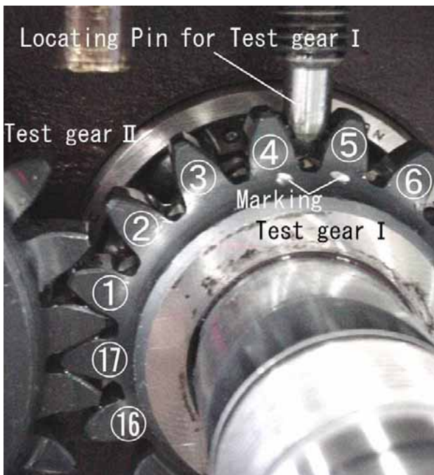
図7 AE測定開始位置を決める位置決めピン
