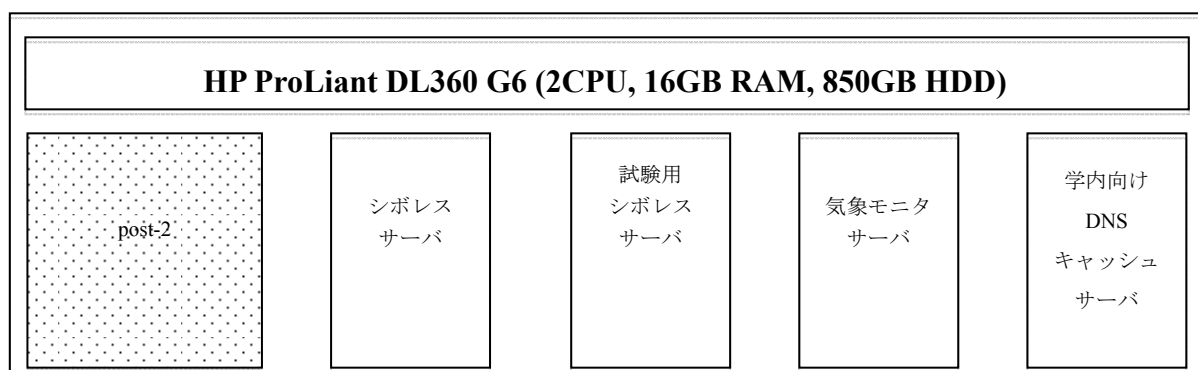
図2 VMware マシン (vmserver09) 1 台目の構成
