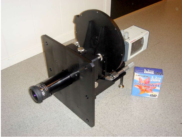
図4 撮像部の外観 左側から、筒状のものが魚眼レンズ、その後ろの円盤状の物がフィルタターレット、一番奥にEMCCDカメラ
