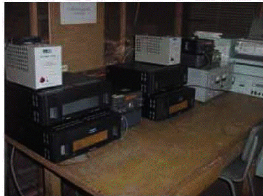
図6. 送信システム外観、左から5,006kHz送信系統、8,006kHz送信系統、ルビジウム発振器
