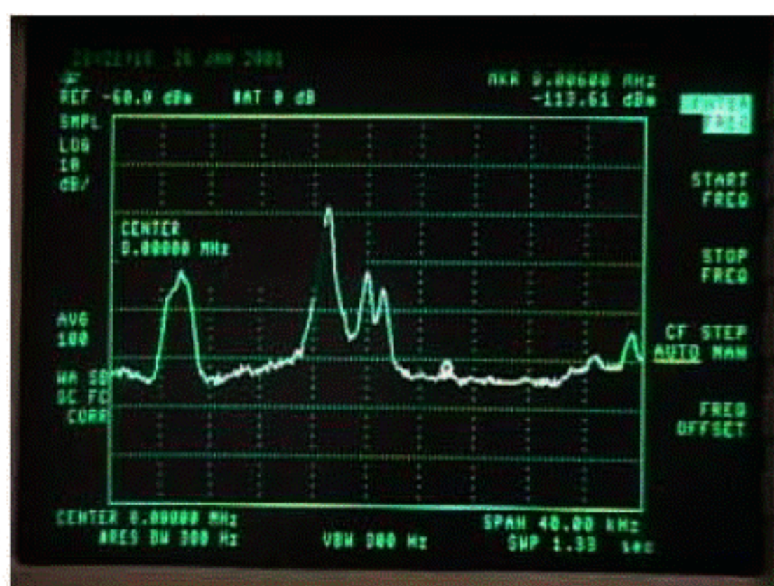
[b] 8MHz帯候補周波数付近のスペクトル監視記録例 (8MHz±20kHz, Bw:300Hz) 2001/1/26 23:15-25JST
