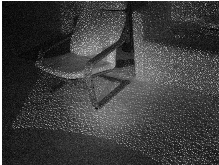
図 24 Kinect による赤外光ドットパターン[13]
