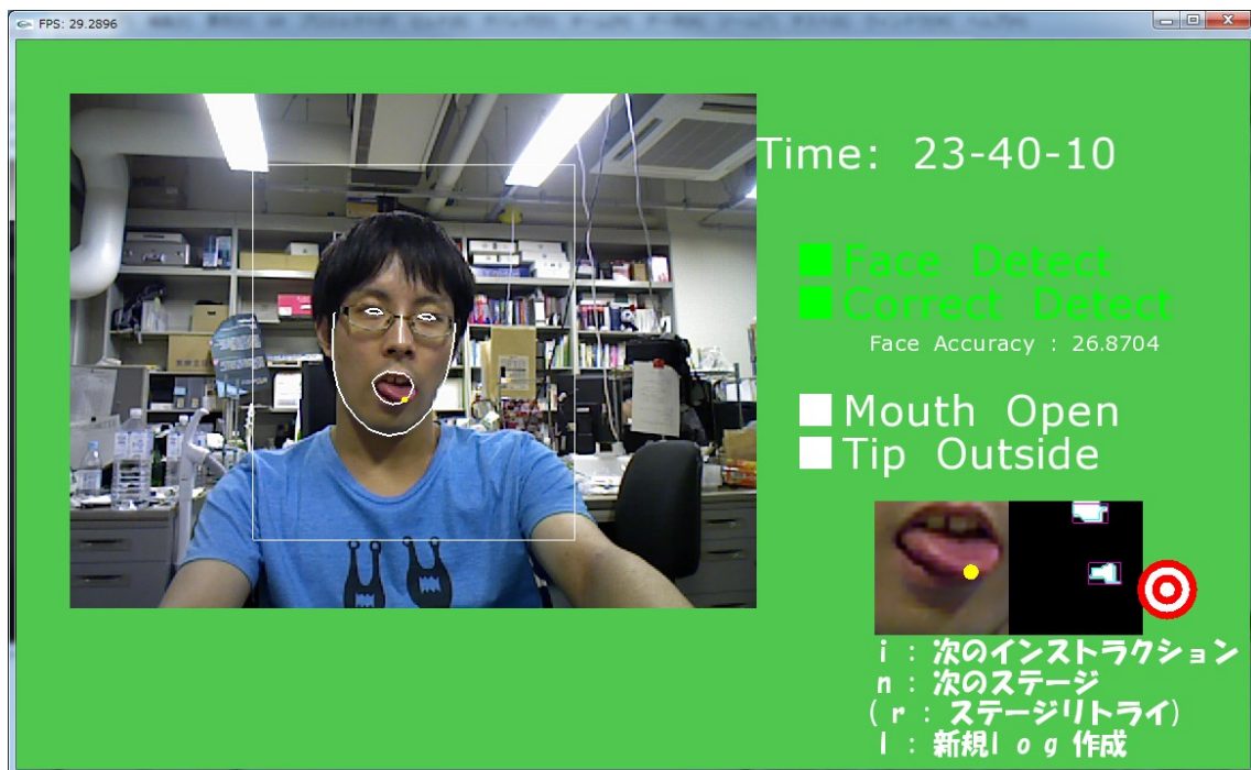
図 27 システム 3 の舌認識アプリケーション (顔認識が正確と判断されている状態の様子)
