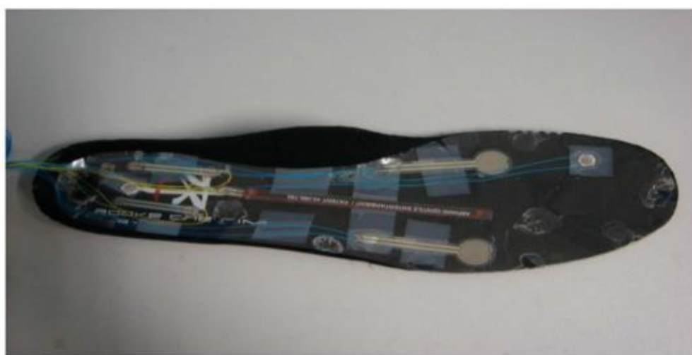
図 13 : 中敷きに設置されたセンサ類
