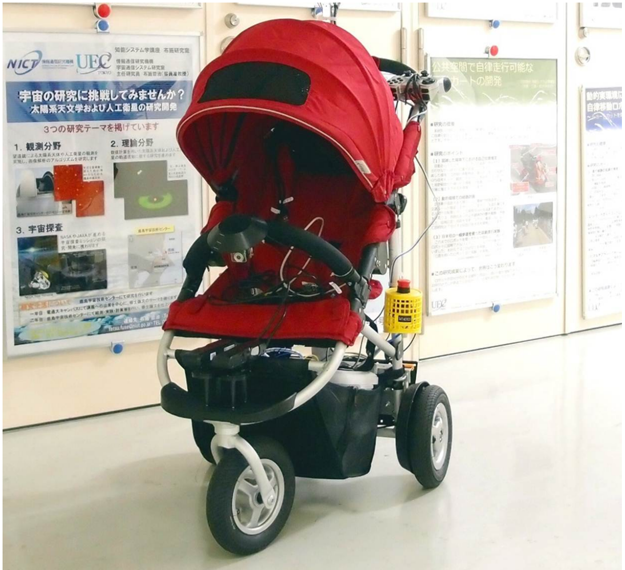
図 3.1: 独立二輪式移動ロボットプラットフォーム CARTIS TypeB
