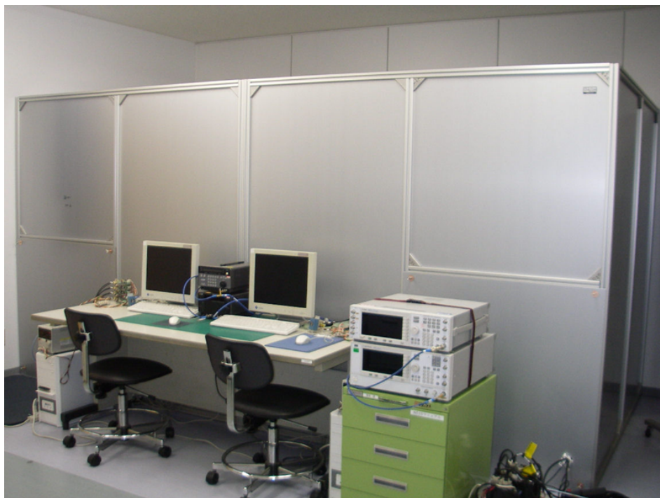
図 1.5 電波反射箱の一例（電気興業）
