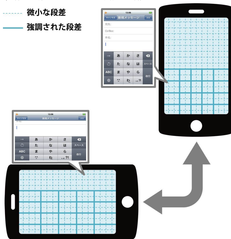
図 8.1 視覚的手掛かりによって、触覚刺激を選択的に強調する
