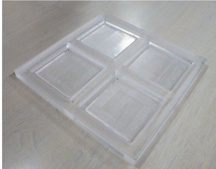
図 5.4 シリコンゴムの型となるアクリル型 (4つの型を1枚のアクリル板に配置したもの)
