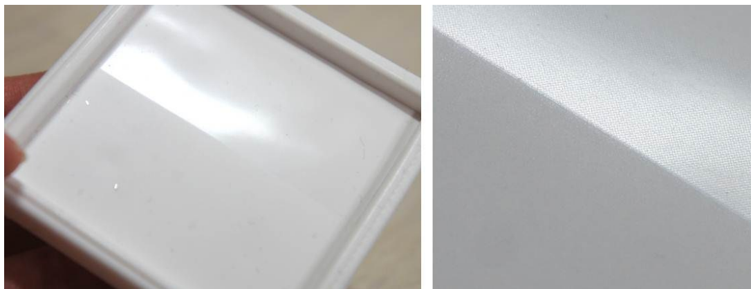
図 5.9 シリコンに転写された、段差部分で異なるテクスチャ (左右で光の反射が異なることが分かる)
