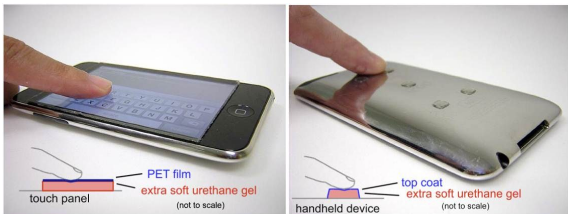
図 1.17 左：端末表面に貼る PuyoSheet, 右：端末裏面に貼る PuyoDots[39]
