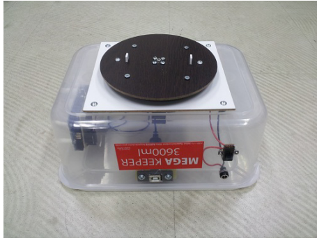
図 10.4: Kinect を回転させる台座の完成図
