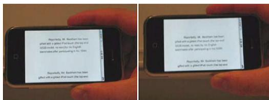
図 2.3: NoShake:画面の表示の安定化
