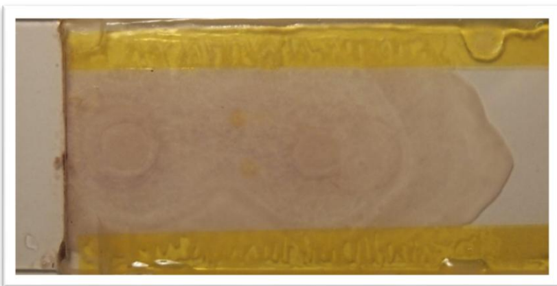
純粋 HAT5 薄膜、膜厚 24\mu\text{m}
