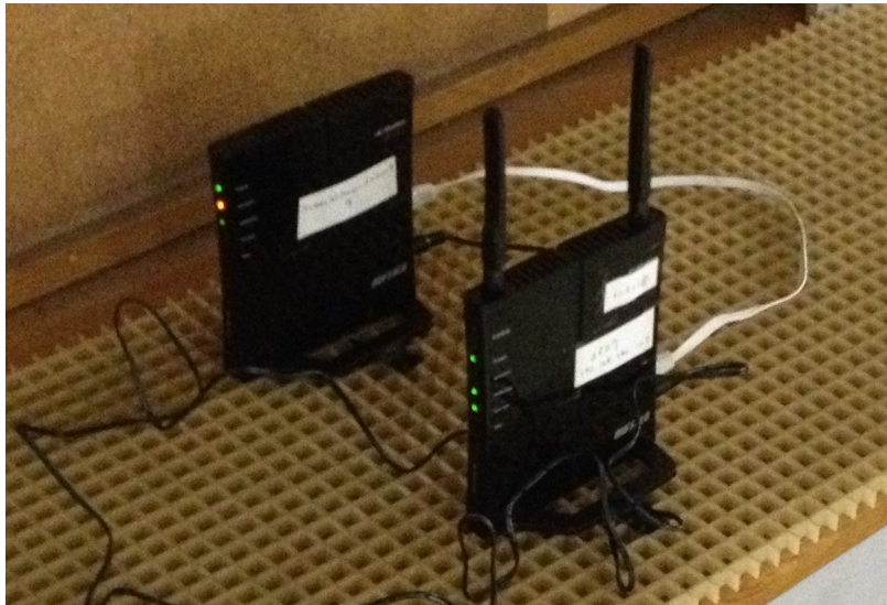
図 19 実験に使用したルータ。奥がネットワーク用、手前が信号キャプチャ用
