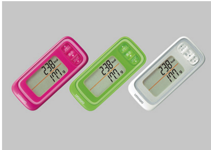
図 1.0.1: 加速度センサを搭載した歩数計（オムロン歩数計 ウォーキングスタイル）[1]
