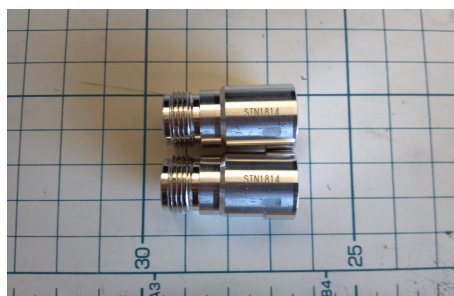
図 6.3 システムパラメータ同定時に使用する整合終端器
