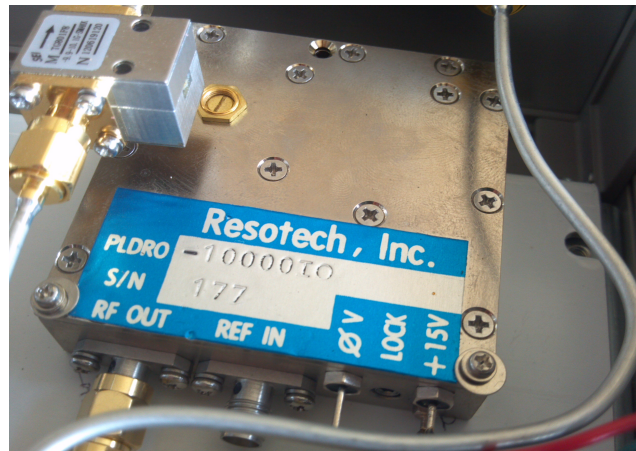
図 5.7 使用した小型発振器
