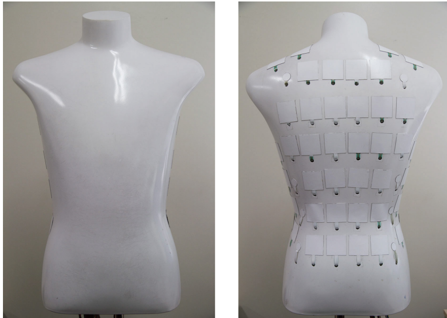
図 3.6: マネキン型センシングデバイス正面（左）及び背面（右）
