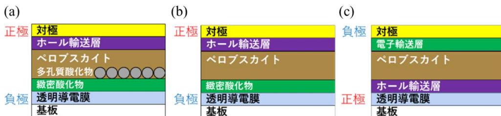
図 2.3.1 ペロブスカイト太陽電池の基本構造、(a)メソポーラス型(順構造型)、(b)プレーナー型(順構造型)、(c)逆構造型
