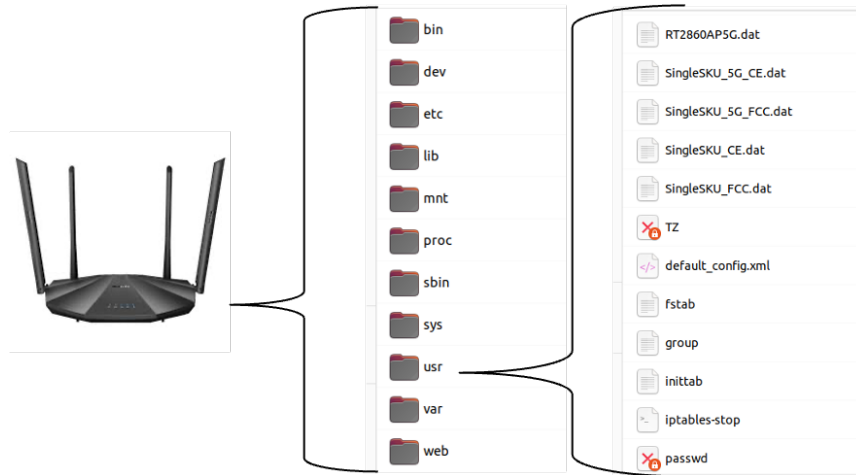
図 2.2: IoT 機器のファームウェアには多数の構成ファイルが含まれている
