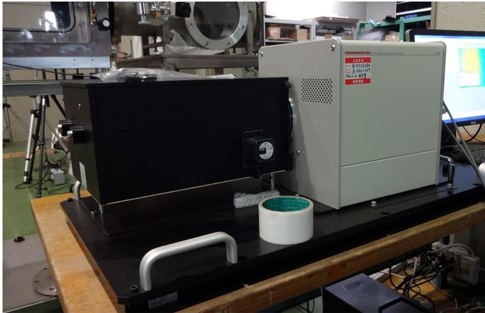
図 2.6: 浜松ホトニクス製高ダイナミックレンジストリークカメラ C7700。蒸気雲の固体壁への衝突による発光のスペクトルを測定する。
