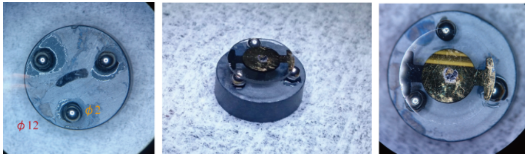
図 4.8 ステンレス球を利用した水晶振動子ホルダーと HOPG 付き SC-cut 水晶振動子.
