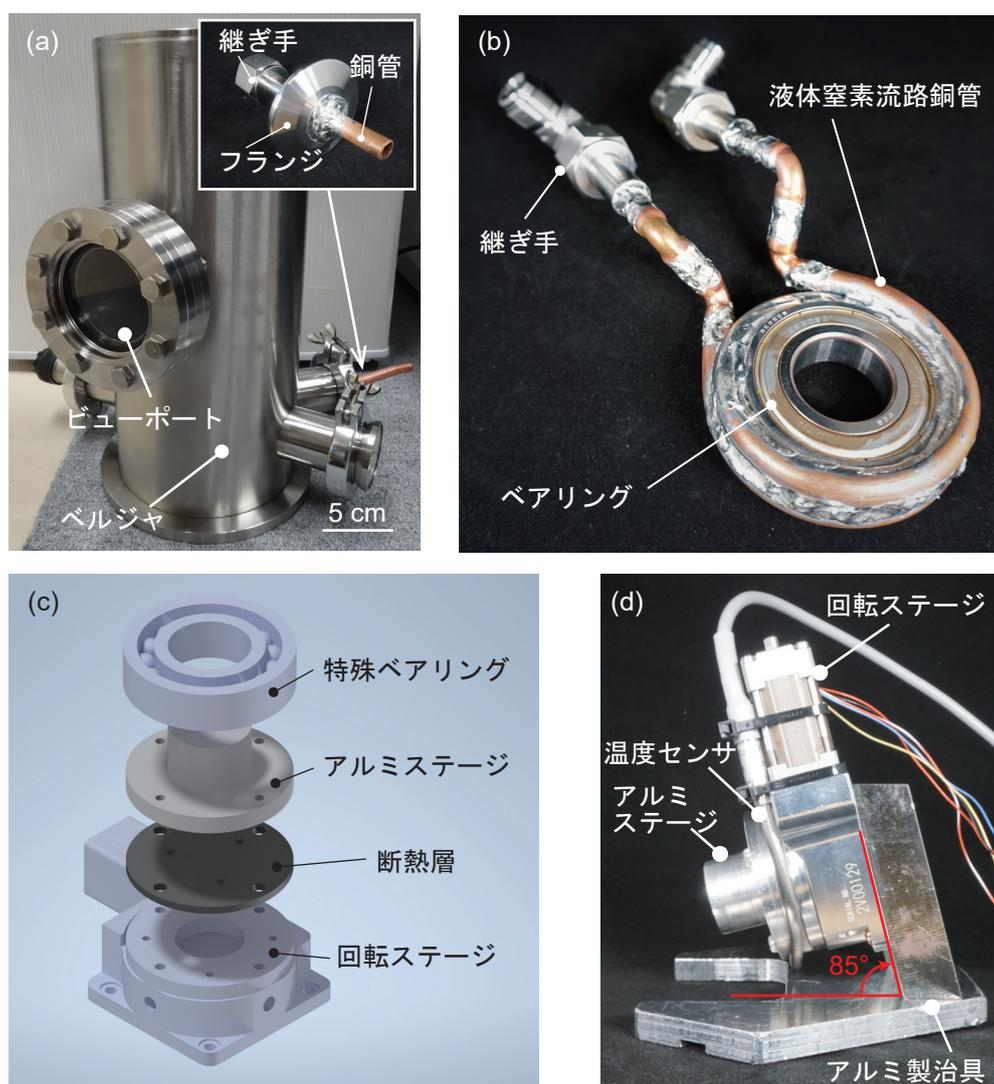
**Fig. 5.3:** 自作真空蒸着装置の構成. (a) 回転ステージなどを取り付けるベルジャの外観. (b) 冷却用の液体窒素の配管を接合した真空・極低温対応の特殊ベアリング. (c) 回転ステージの構成. (d) 回転ステージを  $85^\circ$  で固定する治具や温度センサ.
