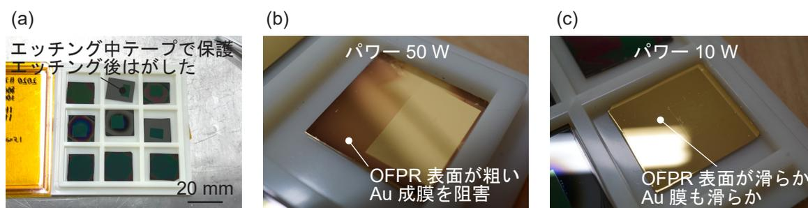
**Fig. 4.20:** 膜厚調整のための OFPR エッチング時のエッチング装置のパワーと表面の滑らかさの関係. (a) レジスト表面をテープで保護してエッチングされる領域とされない領域に分けた. (b) パワー 50 W でエッチレート高めで行うとエッチングされた OFPR 表面が粗くなり Au 成膜を阻害. (c) パワー 10 W ではエッチングされた OFPR 表面はなめらか.
