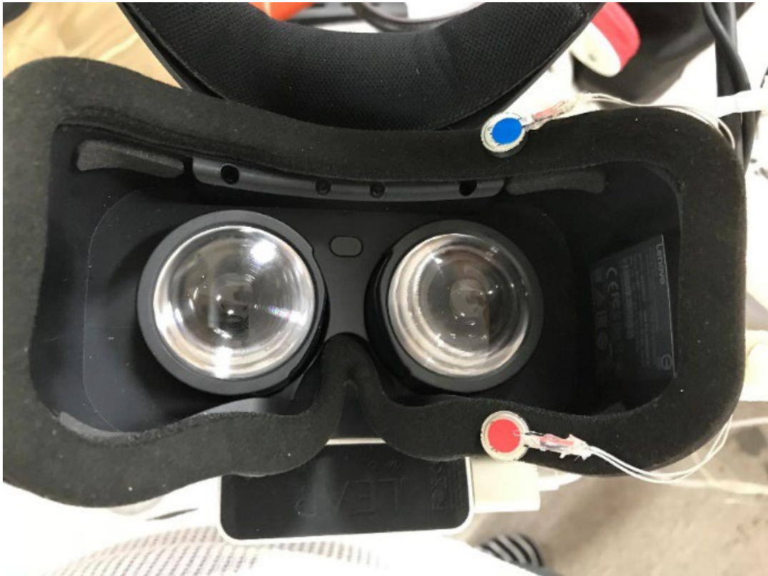
図 3.21 HMD の内側に振動子を取り付けた様子.
