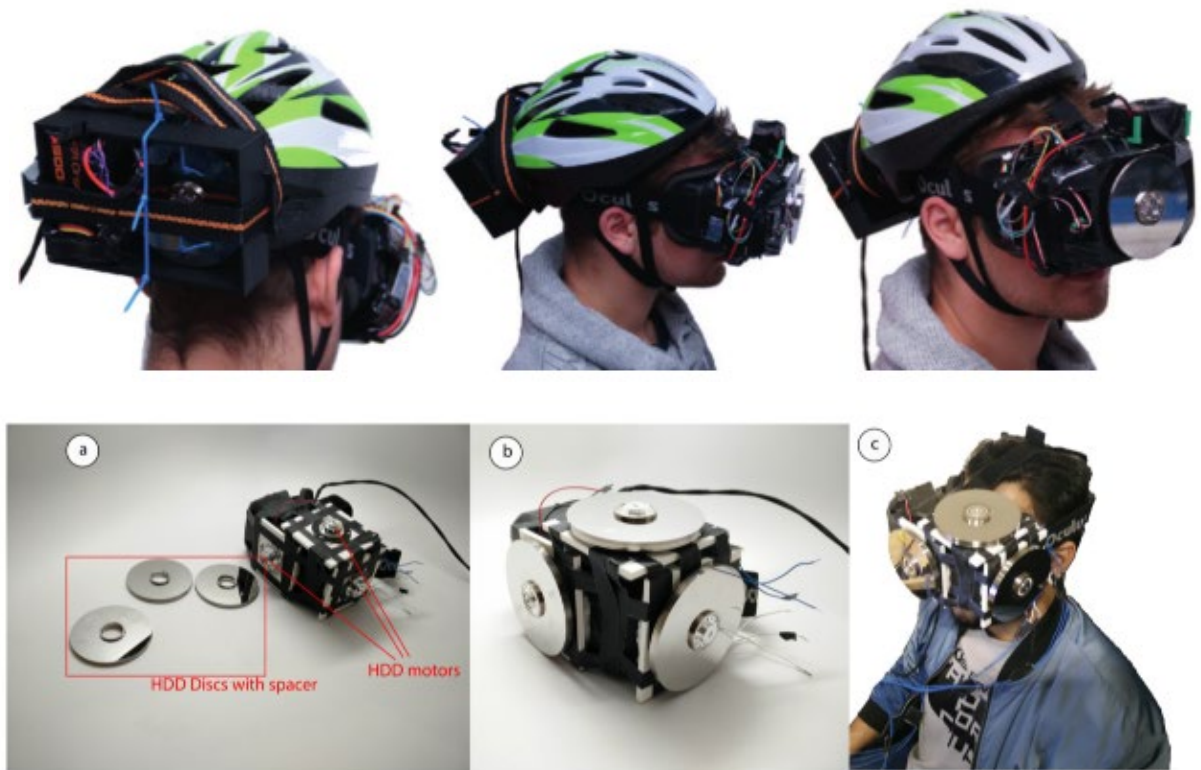
図 2.14 Gugenheimer らによるフライホイールを取り付けた HMD[76]. 回転させたフライホイールはジャイロ効果を生みユーザーへ力覚を提示する.
