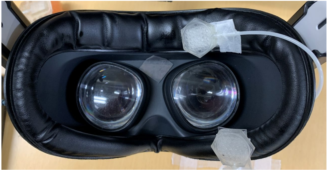
図 4.7 HMD のクッション部へ吸引部を取り付ける様子.
