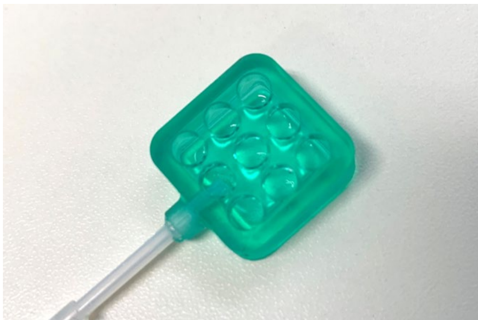
図 3.27 UV レジン製の吸引部。 吸引孔は 5 mm で中心間距離は 6 mm であった。
