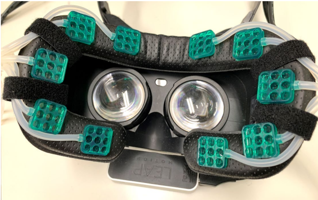
図 3.50 複数吸引点を持つ接触部を搭載した Haptopus. 実際の展示では吸引箇所は両眼の上と下の4箇所制限した。
