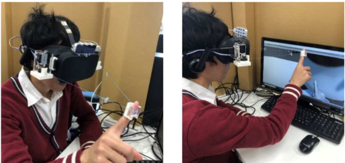
図 2.16 Ooshima らによるワイヤー巻取り式指先触覚提示装置を内蔵した HMD [95].
