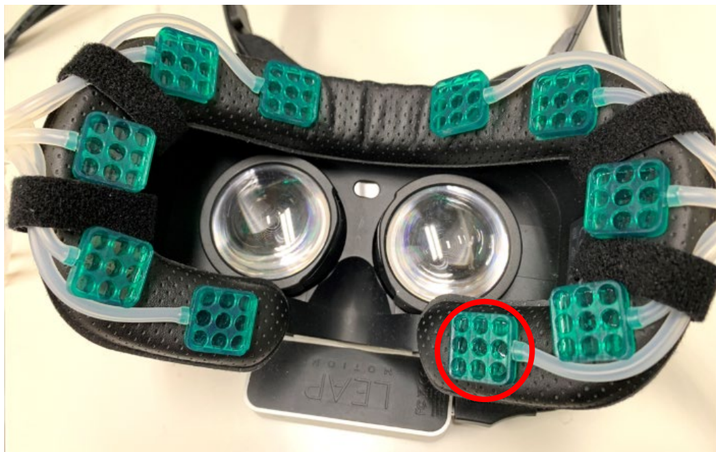
図 3.28 多点吸引部を装着した HMD。 実験では赤い丸をつけた部分の吸引部のみを利用した。
