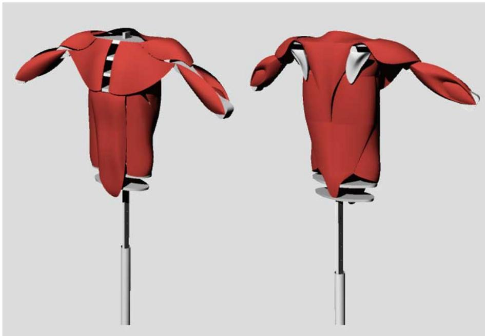
図 6.3 内部骨格の人工筋肉のレイアウト.
