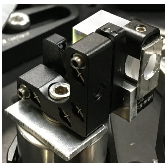
図 5.1 作成した波長板と PBS のセットマウンタ
