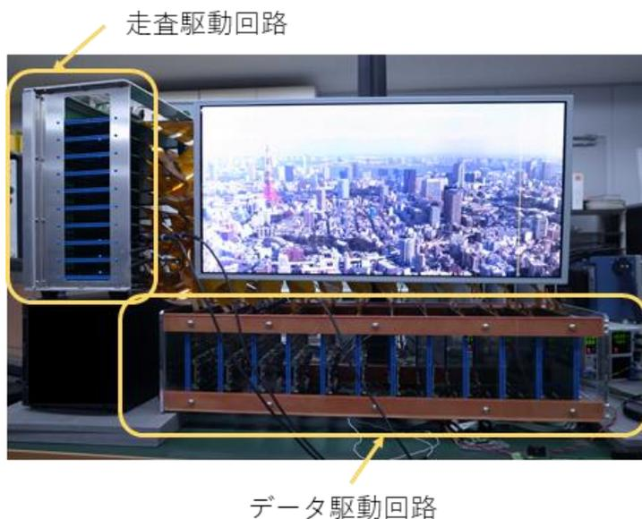
図 4.23 駆動装置の外観
