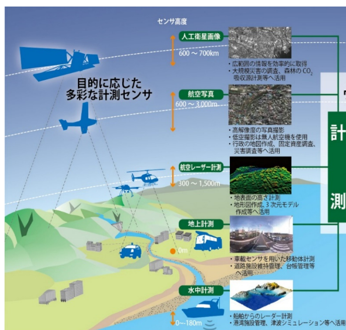
図 1-2 多様な計測センサによる測量 (国際航業株式会社資料[2])
