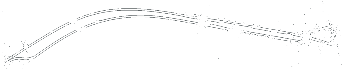
(d) 点群 C による縁石検出結果
