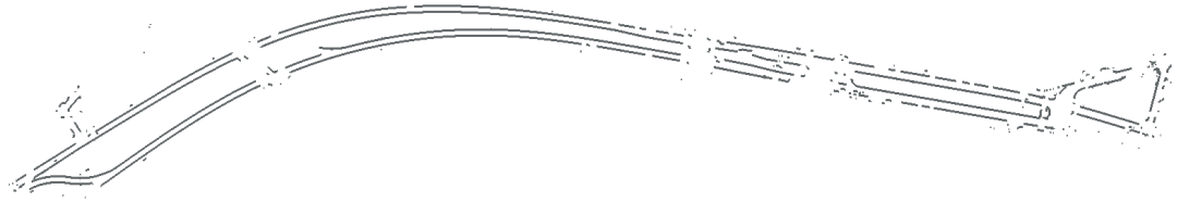
(b) 点群 A による縁石検出結果
