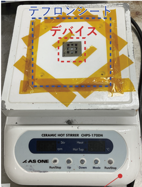
Fig.3.35: (a) フッ酸蒸気エッチング時のセットアップ (b) 概念図 (c) エッチング前 (d) エッチング後
