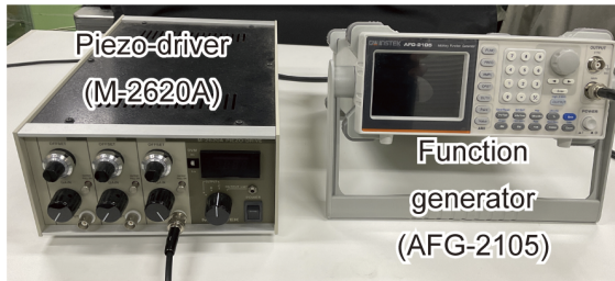
Fig.6.7: ピエゾドライバ (M-2620A, Mess-tek, Japan, Left) 及びファンクションジェネレータ (AFG-2105, GW Instek, Taiwan, Right)
