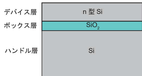
Fig.3.8: SOI ウェハの構造
