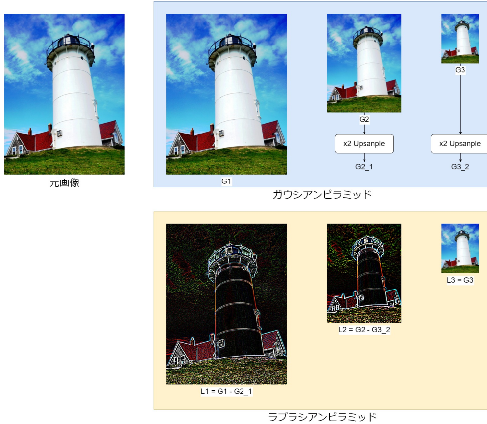
図5 ガウシアンピラミッドとラブラシアンピラミッドの例. 図中の L1 および L2 は画像特徴の視認性を高めるために元画像の各画素値を 16 倍にした画像.
