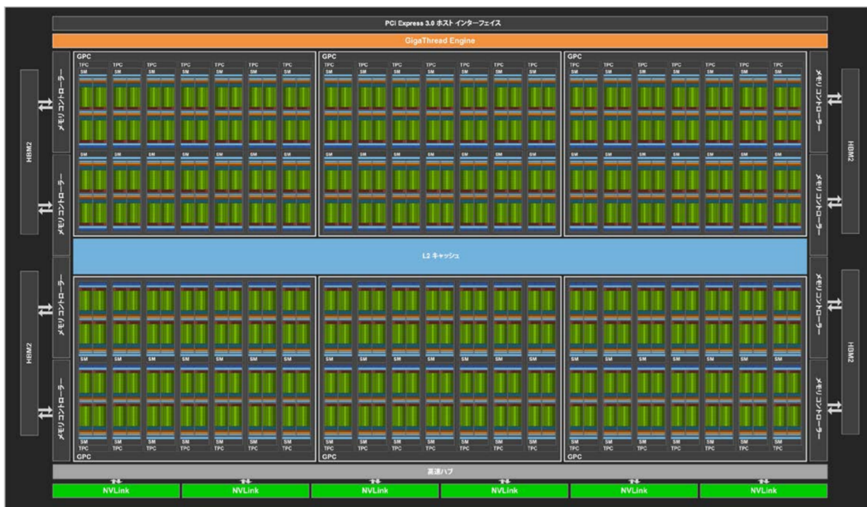
図 2.8: Tesla V100 チップのブロック図 ([34] から引用)。80 個の SM ユニット、6,144 KB の L2 キャッシュなどを搭載している。
