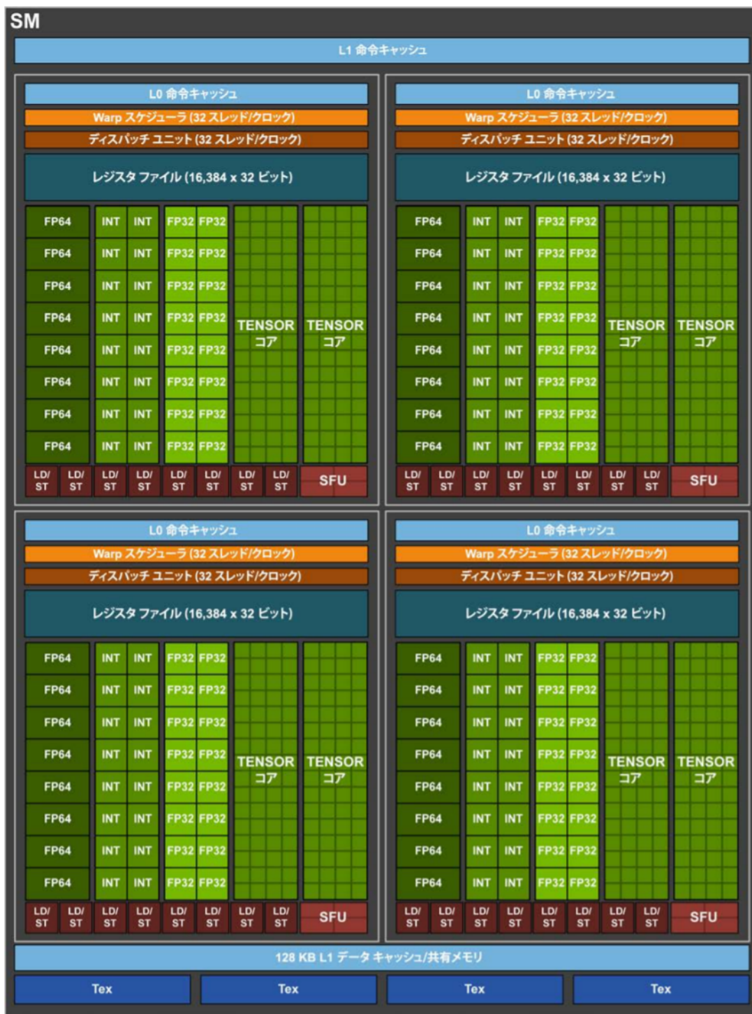
図 2.7: Tesla V100 の SM ユニット ( [34] から引用)。64 個の単精度 CUDA コア、32 個の倍精度 CUDA コアなどから構成されている。
