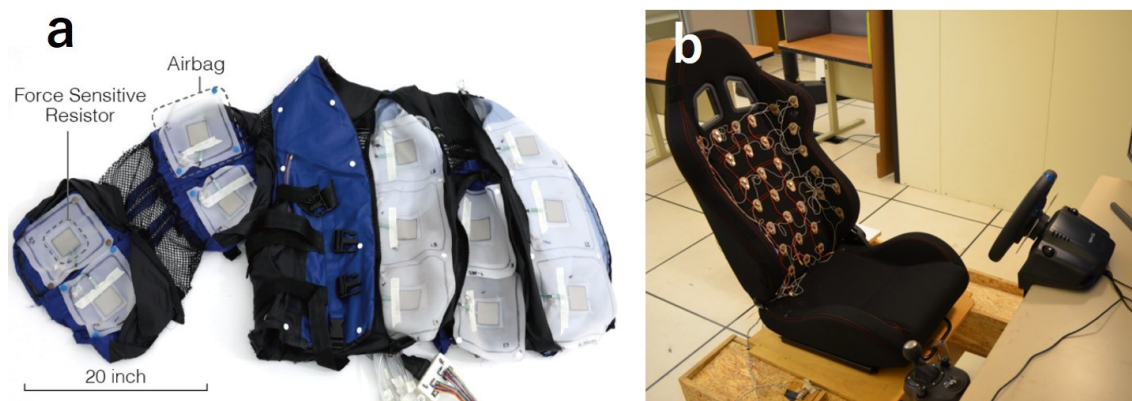
図 5-2 : a) 空気圧迫モジュールを内蔵したベストが圧覚デバイス[65], b) 振動子を大量に椅子に埋め込んだ振動提示デバイス[66]
