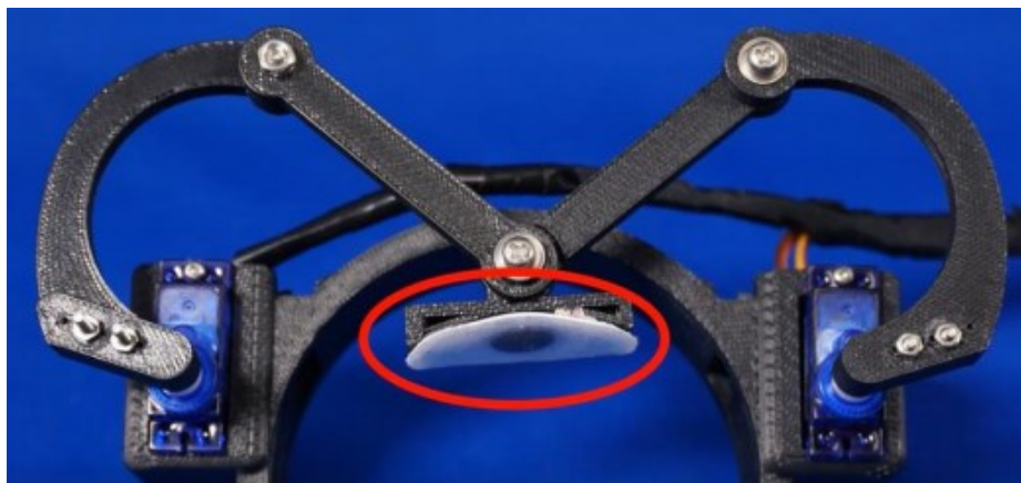
図 3-16：5 節リンク機構の中央節に粘着ゲルシールを設置
