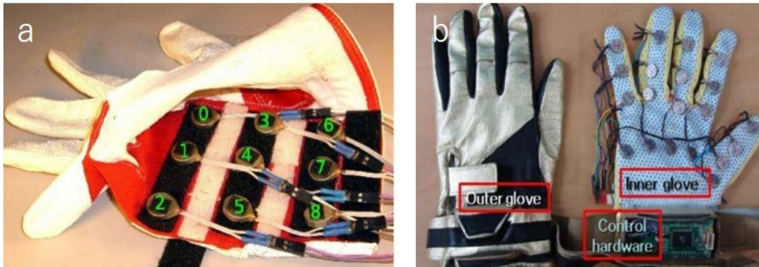
図 3-2 : a)振動子を手掌部に配置したグローブ形状の振動触覚提示デバイス[12], b) 振動子を指や手掌部全体に配置した振動触覚提示デバイス[13]
