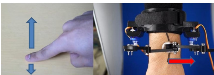
図 3-19 : せん断力提示 (2 節のモータを同じ方向に駆動)
