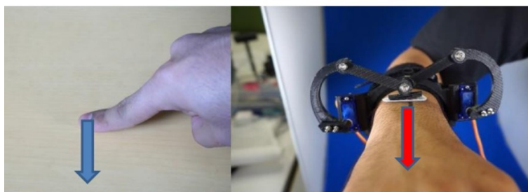
図 3-18 : 圧覚の提示 (2 節のモータを反対方向に駆動)
