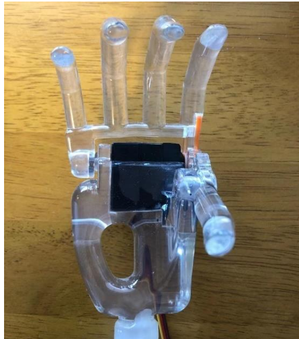
Fig.5.14 五指が共に屈伸するタイプの筋電義手
