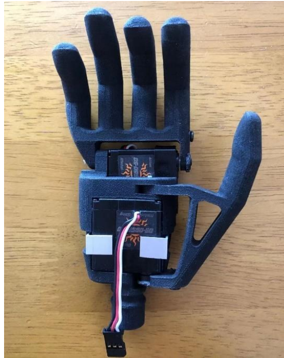
Fig.5.15 四指が屈伸・拇指が回転するタイプの筋電義手
