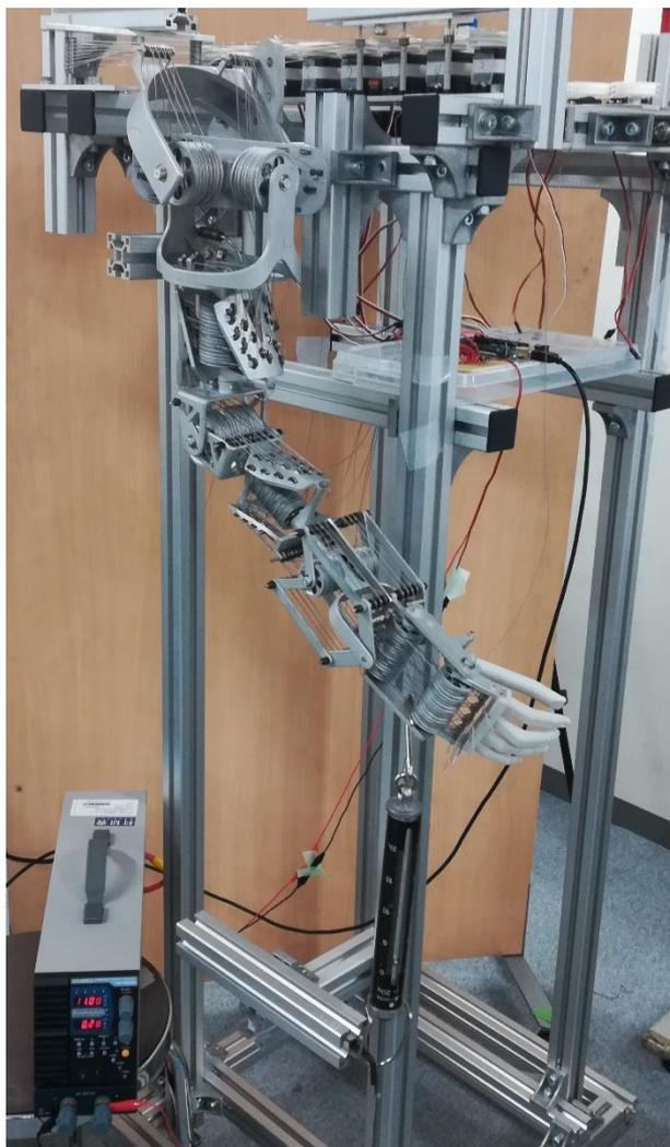
図 4-46 8軸ワイヤ干渉駆動機構アームの出力確認のための実験環境
