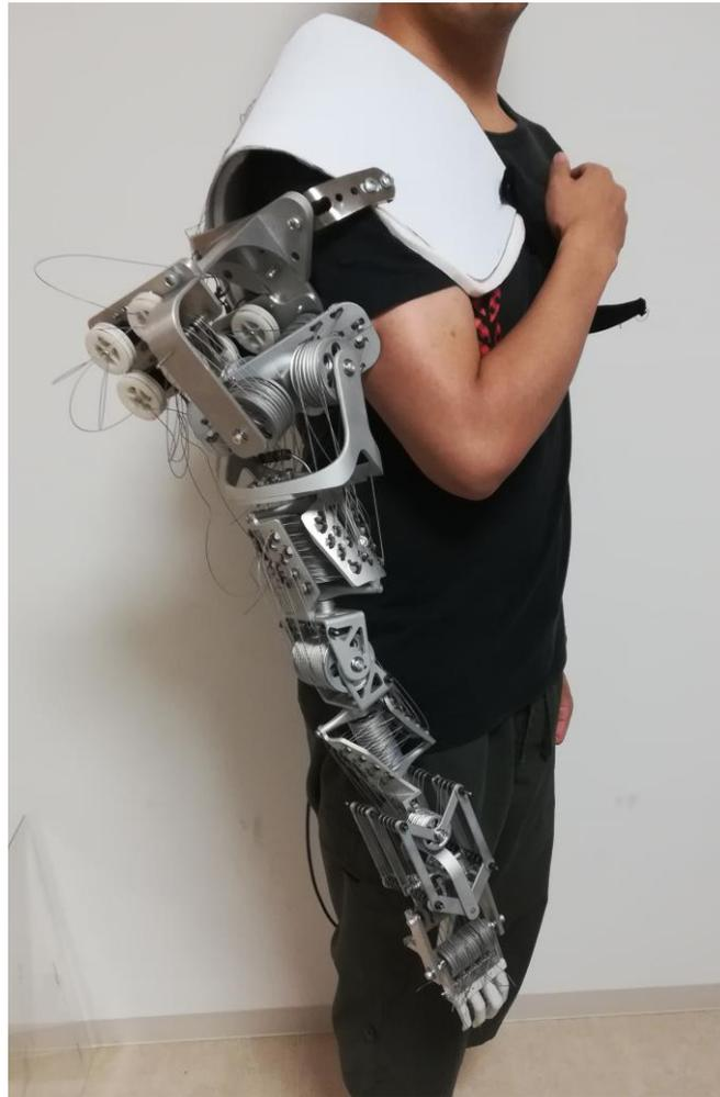
図 4-19 8 自由度筋電肩義手システム
