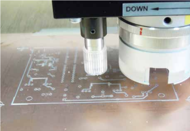
図10. 実験実習支援センターで開発のために新規導入した基板加工機による試作
