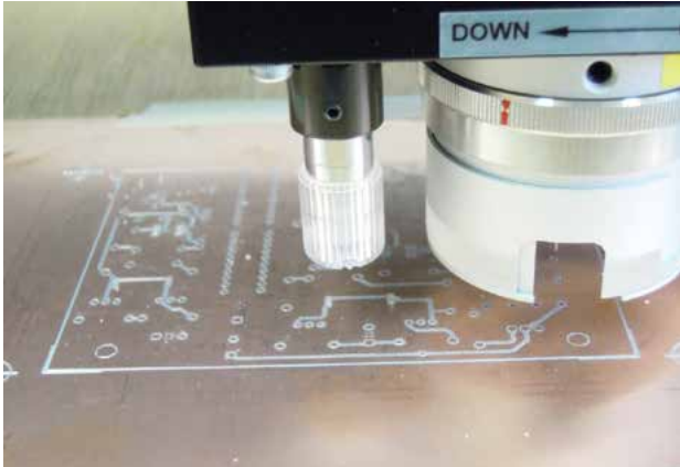
図10. 実験実習支援センターで開発のために新規導入した基板加工機による試作
