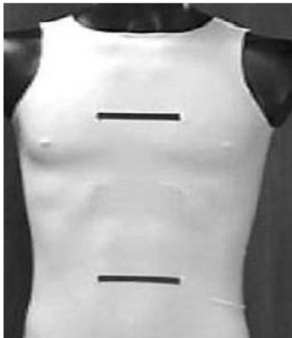
図 2.14 着衣縫込み型圧力センサ
