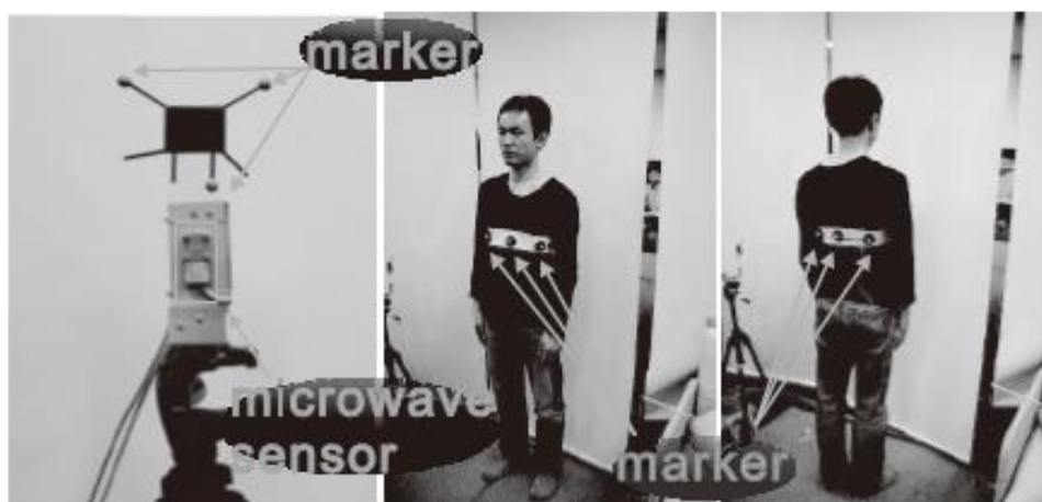
図 2.30 マイクロ波ドップラーセンサを用いた呼吸数計測実験の様子
