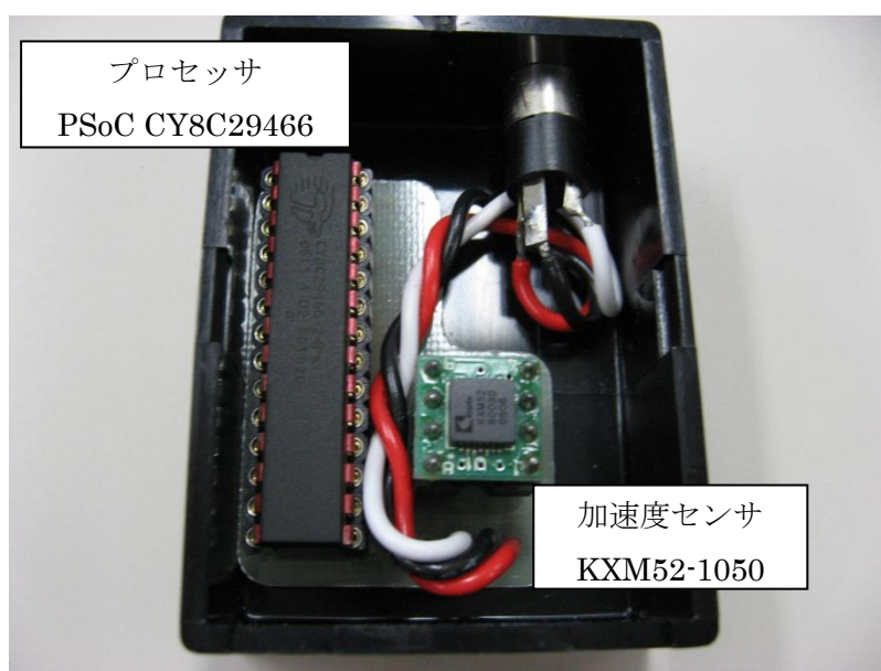
図 5.69 試作胸部運動量センサ
